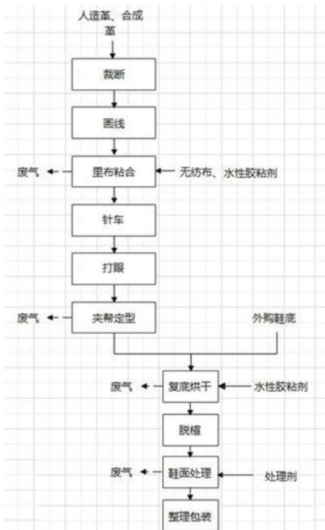
图 2-7 冷粘鞋生产工艺流程及产污环节示意图
