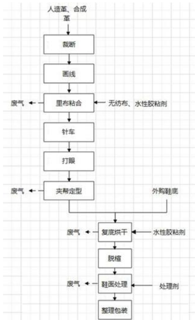
图 6 冷粘鞋生产工艺流程及产污环节示意图
